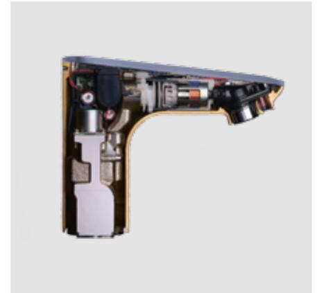
Die praktisch wartungsfreie Armatur, die sich selbst mit Strom versorgt. Die Automatikarmatur mit integrierter Steuereinheit hat die gleichen Merkmale wie die anderen TOTO Automatikarmaturen. Nur ist hier keine externe Steuereinheit mehr nötig, da die gesamte Technik in der Armatur selbst integriert ist.
