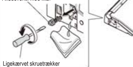
Afløbsventil med filter
