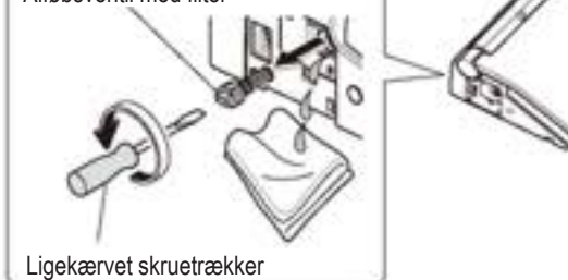
Afløbsventil med filter
